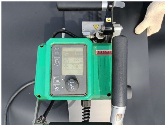
ภาพที่ 7 อุณหภูมิ (เซลเซียส) และแรงกด (นิวตัน) ของเครื่องเชื่อมแผ่น Geomembrane ด้วยความร้อน
