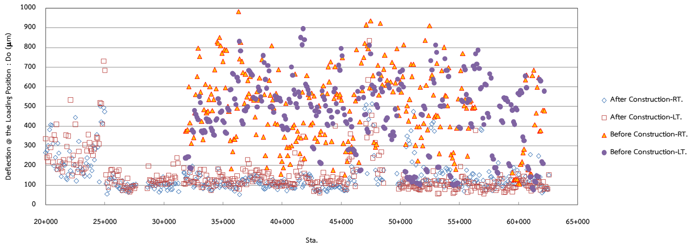
ภาพที่ 6.1 รูปแสดงค่าการยุบตัวจากการทดสอบ FWD ที่ตำแหน่ง Loading Plate ก่อนก่อสร้างและหลังการก่อสร้างประมาณ 0.5 ปี
