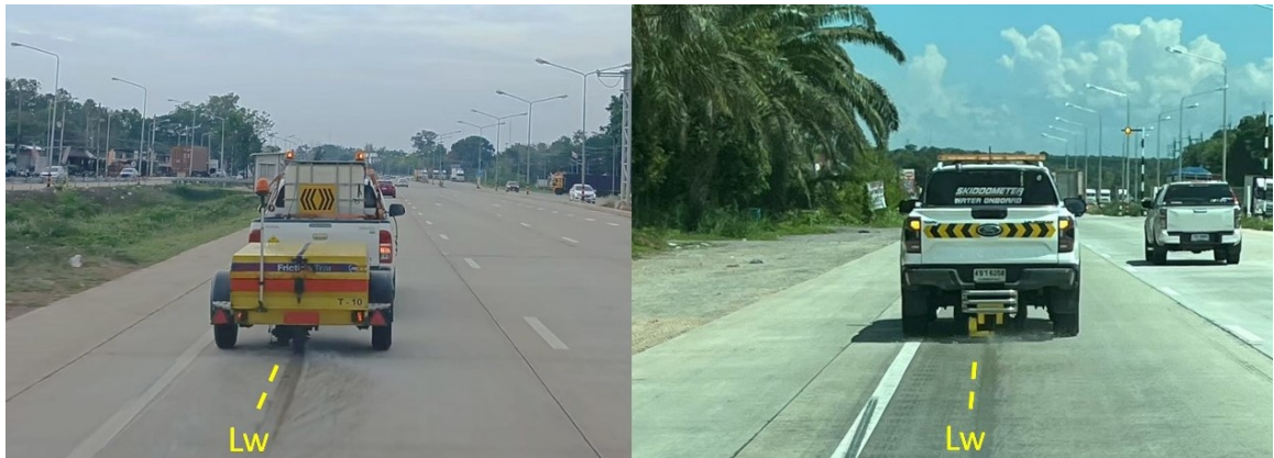
ภาพที่ 18 การทดสอบความเสียดทานของผิวทางที่ร่องล้อซ้าย (Lw) ของช่องจราจรด้านนอกสุด
