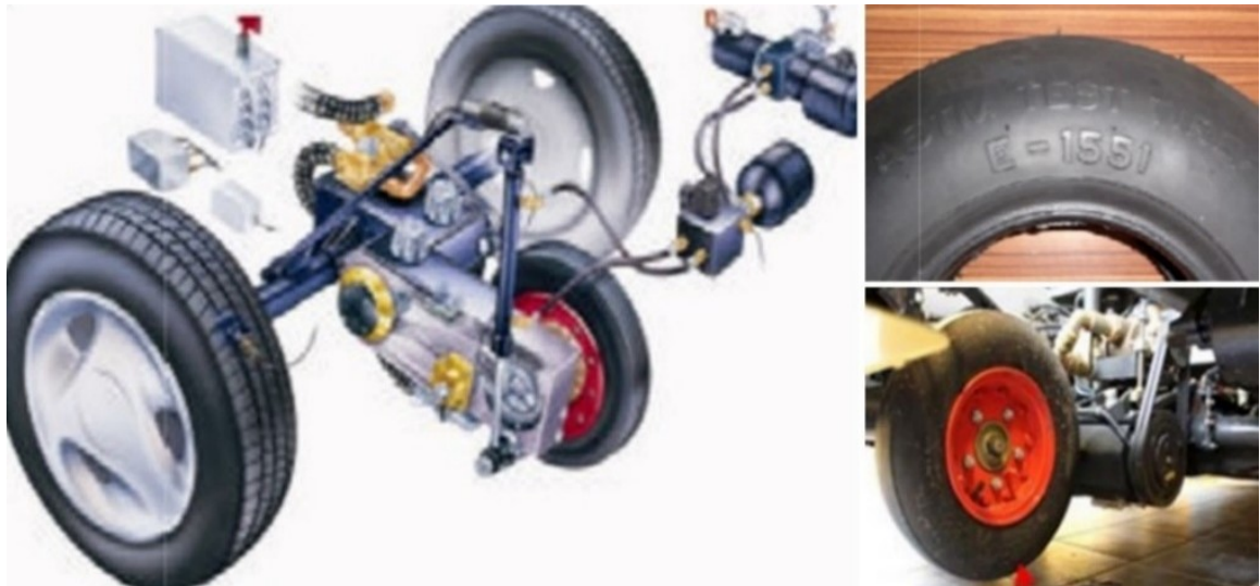
ภาพที่ 12 ชุดเครื่องมือวัดแรงเสียดทานแบบ Fixed-Sip ของ ASFT T-10 และยางทดสอบ
