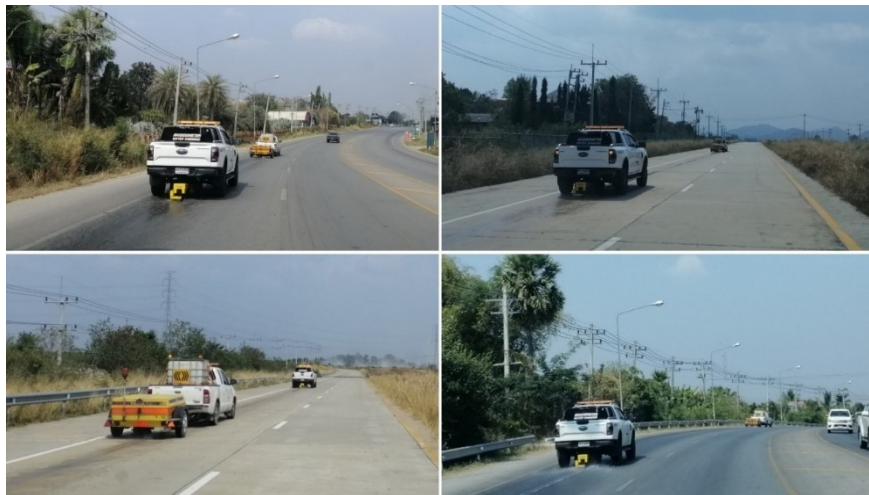
ภาพที่ 15 การสอบเทียบเครื่องมือ ASFT T-10 กับ Skiddometer BV11 VI
