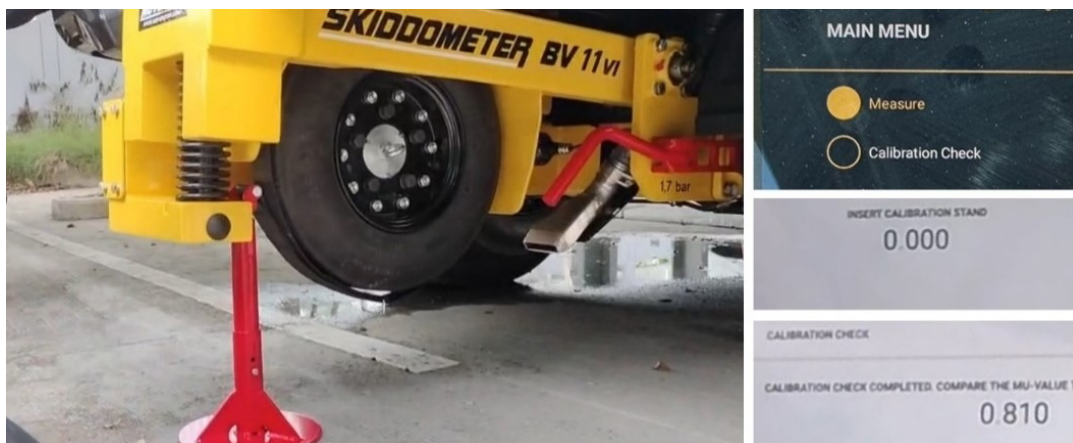
ภาพที่ 21 การสอบเทียบค่าความเสียดทานของล้อทดสอบ Skiddometer BV11 VI
