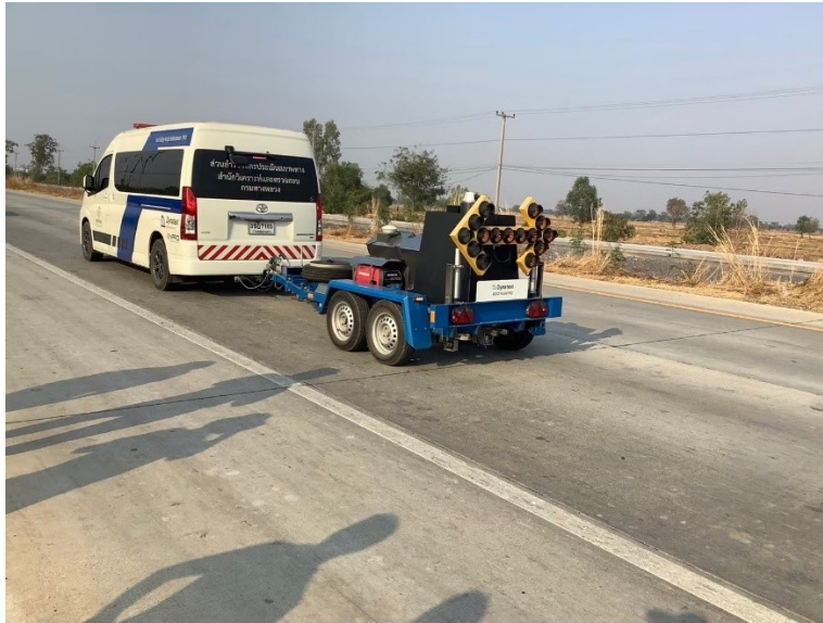
ภาพที่ 5 การจัดเก็บค่าความแข็งแรงของโครงสร้างชั้นทาง ด้วยเครื่อง Falling Weight Deflectometer
