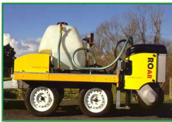
รูปที่ 2-6 รถทดสอบความลื่นแบบ Fixed Slip และ Variable Slip ตามลำดับ
