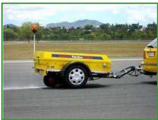
รูปที่ 2-6 รถทดสอบความลื่นแบบ Fixed Slip และ Variable Slip ตามลำดับ
