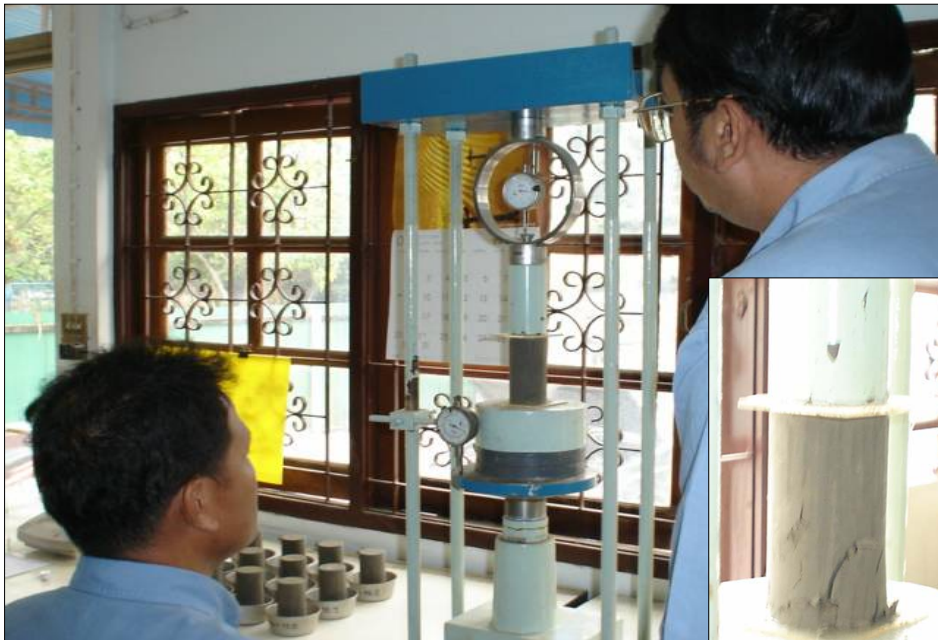
ภาพแสดงการทดสอบ Unconfined Compression Test
