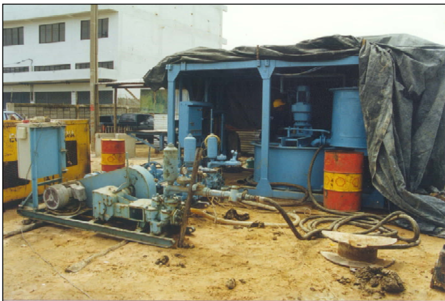
ภาพแสดงปั๊มอัดฉีด Slurry
