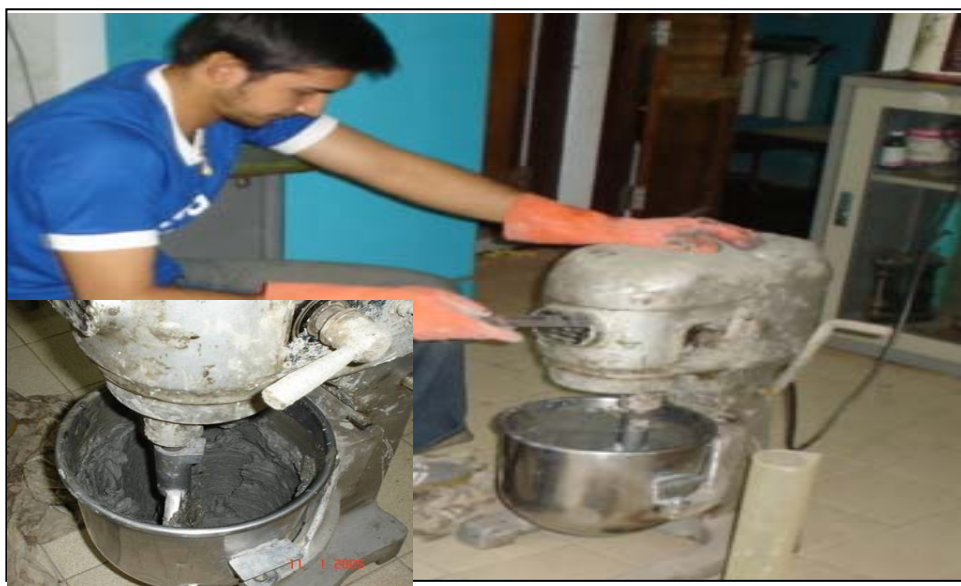
ภาพแสดงการนำตัวอย่างดินเดิมผสมกับสารผสมในห้องทดลอง
