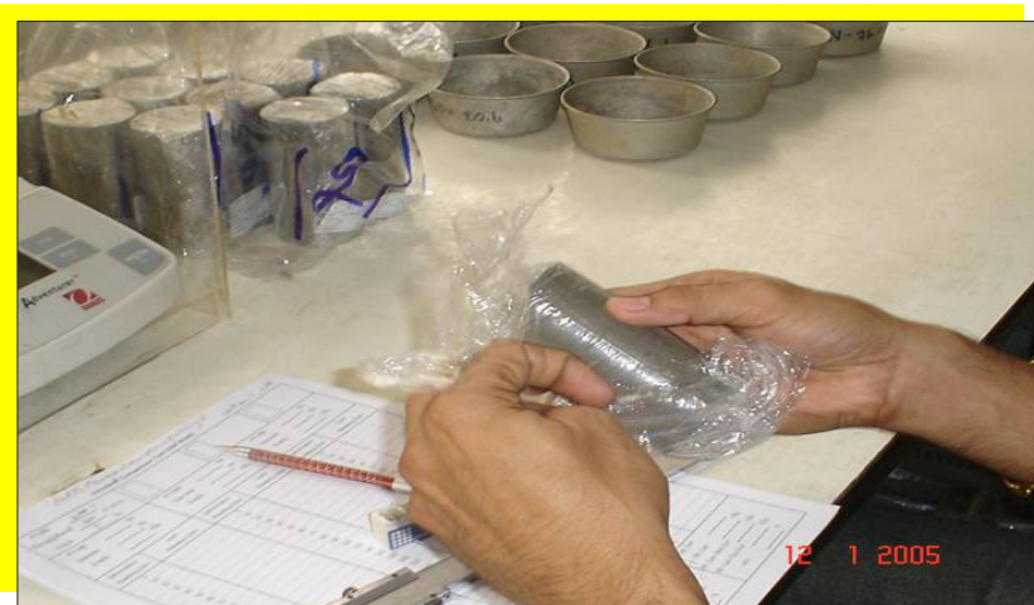
ภาพแสดงการทำแท่งตัวอย่างและการบ่มตัวอย่าง
