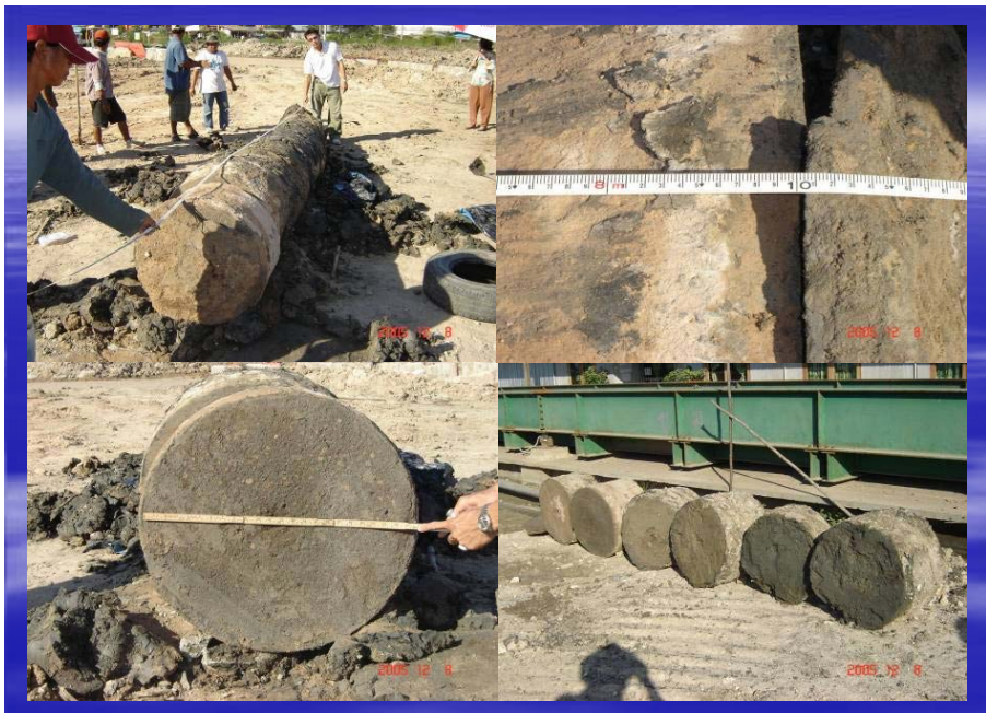
ภาพแสดงการวัดความยาวและขนาดเส้นผ่าศูนย์กลางของ Column
