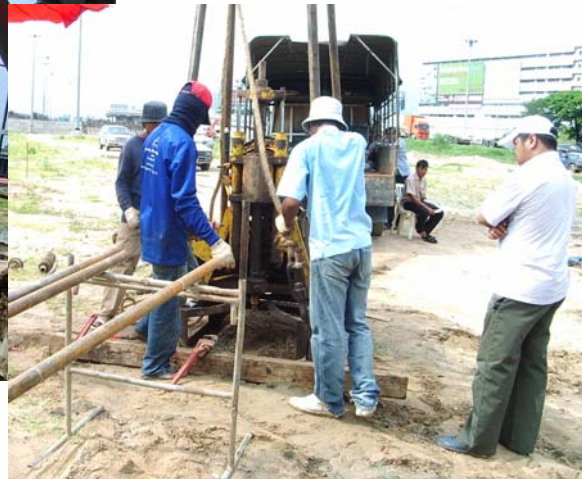
ภาพแสดงการเจาะเก็บตัวอย่างเพื่อนำไปทดสอบ
