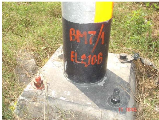
รูปที่ 2.3 การถ่ายค่าระดับไปไว้ที่หมุดหลักฐานชั่วคราว
