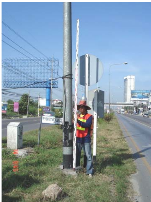
รูปที่ 2.3 การถ่ายค่าระดับไปไว้ที่หมุดหลักฐานชั่วคราว
