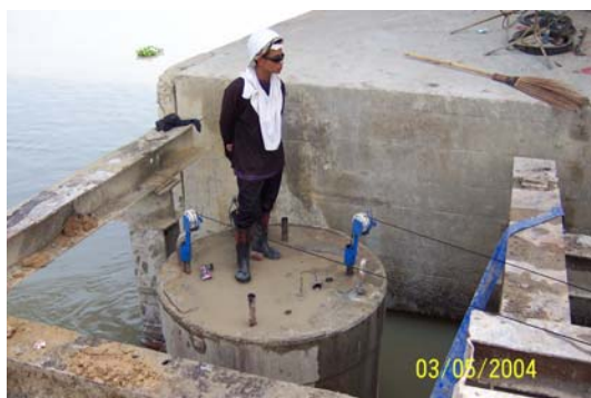
รูปที่ จ.4 การทดสอบความสมบูรณ์ของเสาเข็มเจาะ โดยวิธี Sonic Logging Test
