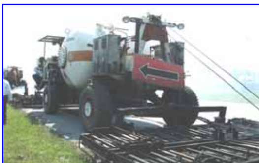
รูปที่ 10.2 เครื่อง Pre - heater
