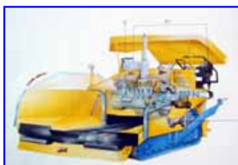
รูปที่ 13 รูปตัดแสดงส่วนประกอบของเครื่องปูส่วนผสมแอสฟัลต์คอนกรีต
