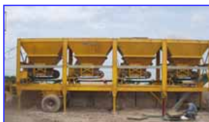
รูปที่ 3 ตู้หั่นเย็นและเครื่องป้อนหั่น
