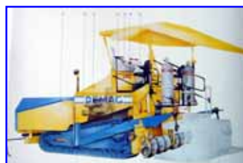
รูปที่ 13 รูปตัดแสดงส่วนประกอบของเครื่องปูส่วนผสมแอสฟัลต์คอนกรีต
