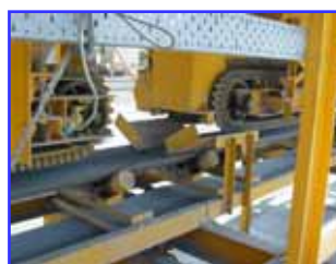
รูปที่ 3 ตู้หั่นเย็นและเครื่องป้อนหั่น
