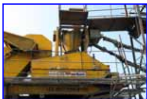
รูปที่ 9 ถังชั่งมวลรวมและถังชั่งแอสฟัลต์ซีเมนต์
