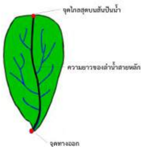
รูปที่ 2.1-2 ความหมายของความยาวบนลำน้ำสายหลัก
