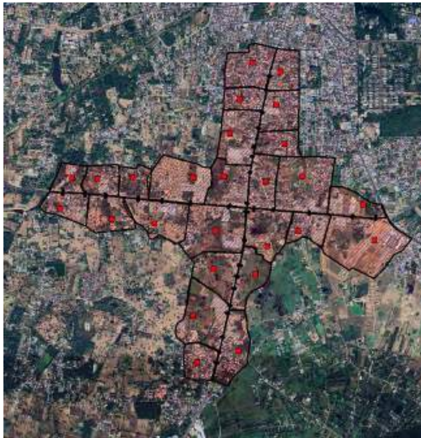
รูปที่ 5.2-9 การแบ่งพื้นที่ย่อยรับน้ำ ของพื้นที่เป้าหมายพื้นที่ที่ 5 บริเวณทางหลวงหมายเลข 231 (กม. 13+000 - 16+300) และ 2178 (กม.1+891 - 5+291) แขวงทางหลวงอุบลราชธานีที่ 1
