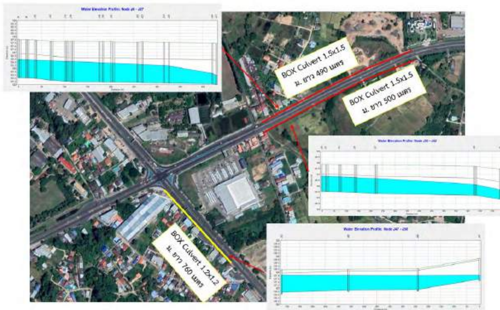
รูปที่ 5.3-33 แผนผังและผลการวิเคราะห์จากแบบจำลองกรณีการปรับปรุงระบบระบายน้ำในพื้นที่ที่ 1 บริเวณทางหลวงหมายเลข 23 (กม. 172+352 -175+852) 202 (กม.258+777 - 259+677) และ 292 (กม.0+000 - 0+750) แขวงทางหลวงยโสธร
