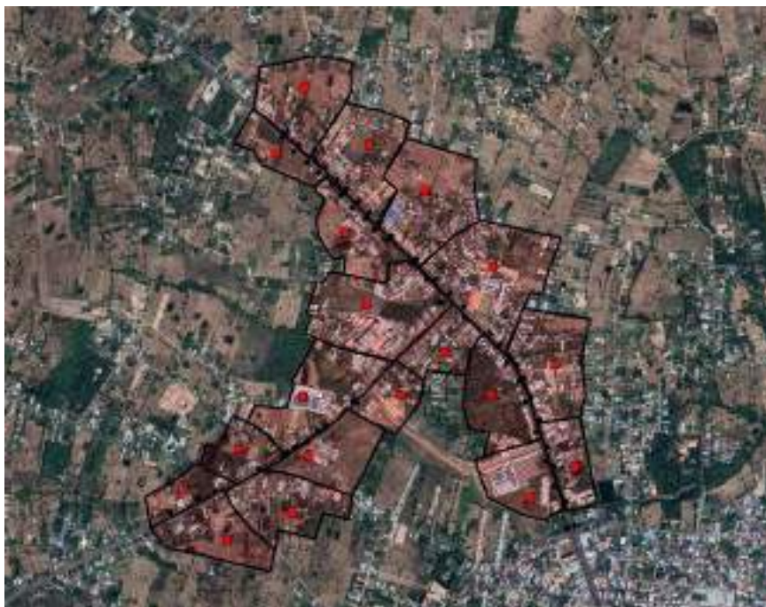
รูปที่ 5.2-11 การแบ่งพื้นที่ย่อยรับน้ำ ของพื้นที่เป้าหมายพื้นที่ที่ 7 บริเวณทางหลวงหมายเลข 24 (กม. 377+000 - 380+000) และ 2191 (กม.0+000 - 1+200) แขวงทางหลวงอุบลราชธานีที่ 2
