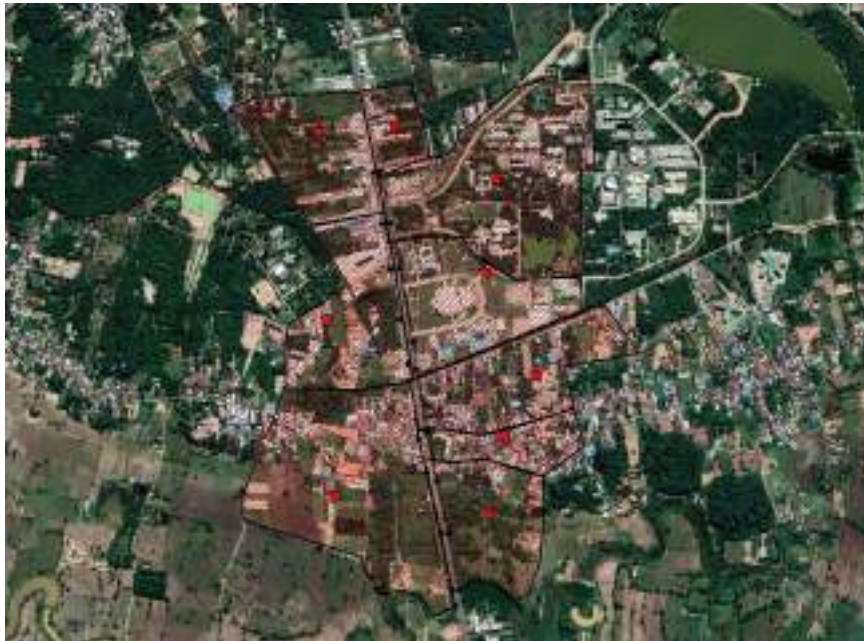
รูปที่ 5.2-10 การแบ่งพื้นที่ย่อยรับน้ำ ของพื้นที่เป้าหมายพื้นที่ที่ 6 บริเวณทางหลวงหมายเลข 24 (กม. 406+100 - 408+500) แขวงทางหลวงอุบลราชธานีที่ 2
