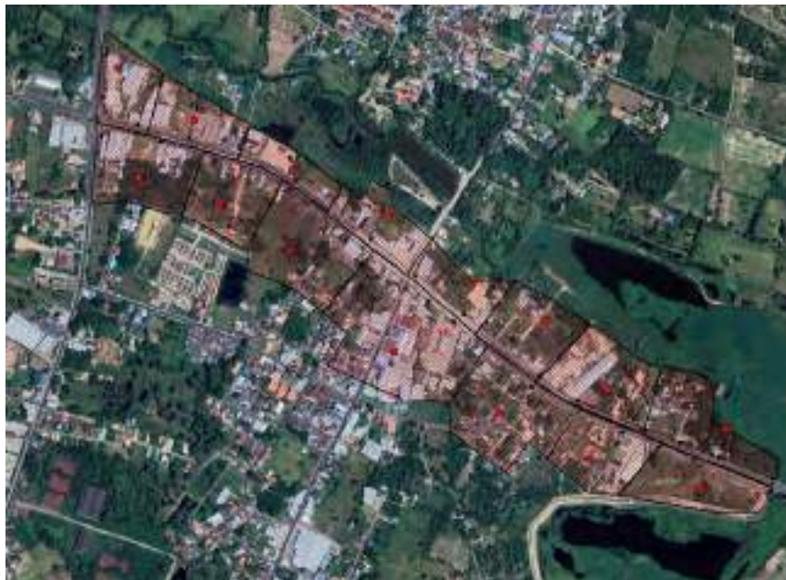
รูปที่ 5.2-6 การแบ่งพื้นที่ย่อยรับน้ำ ของพื้นที่เป้าหมายพื้นที่ที่ 2 บริเวณทางหลวงหมายเลข 292 (1+900 - 4+400) แขวงทางหลวงยโสธร
