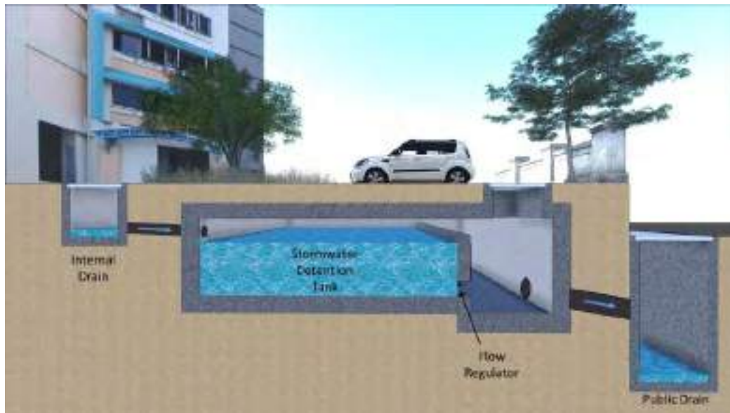
รูปที่ 9.2-1 การกำหนดพื้นที่เก็บกักหรือพื้นที่หน่วงน้ำใต้อาคารหรือสิ่งปลูกสร้าง
