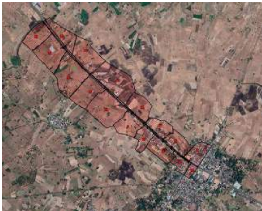
รูปที่ 5.2-8 การแบ่งพื้นที่ย่อยรับน้ำ ของพื้นที่เป้าหมายพื้นที่ที่ 4 บริเวณทางหลวงหมายเลข 23 (กม. 198+200 - 202+000) แขวงทางหลวงยโสธร
