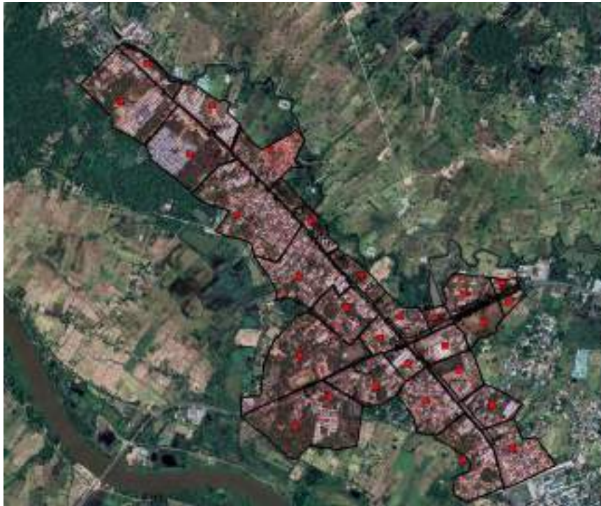
รูปที่ 5.2-5 การแบ่งพื้นที่ย่อยรับน้ำ ของพื้นที่เป้าหมายพื้นที่ที่ 1 บริเวณทางหลวงหมายเลข 23 (กม. 172+352 - 175+852) 202 (กม.258+777 - 259+677) และ 292 (กม.0+000 - 0+750) แขวงทางหลวงยโสธร
