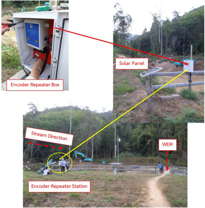
รูปที่ 30 สถานีส่งสัญญาณบริเวณฝายชลประทานห้วยน้ำแก้ว (repeater station) ที่มา: สุทธิศักดิ์ และคณะ (2558)
