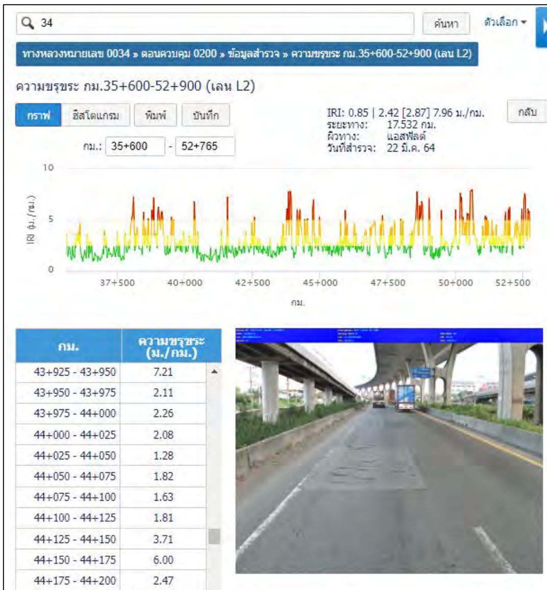
รูปที่ 1-115 กราฟข้อมูลค่าดัชนีความขรุขระสากล (IRI) ที่สภาพความเสียหายสอดคล้องในพื้นที่
