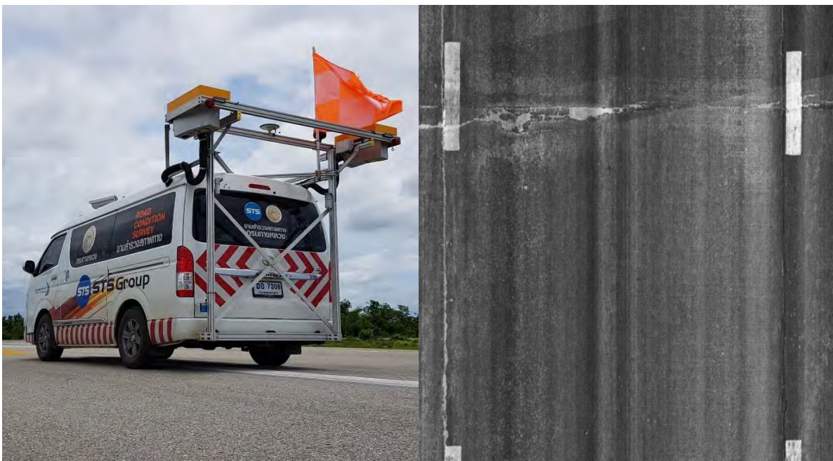
รูปที่ 1-19 อุปกรณ์ถ่ายภาพผิวทาง (LCMS) และตัวอย่างภาพจากอุปกรณ์ถ่ายภาพผิวทาง (LCMS)
