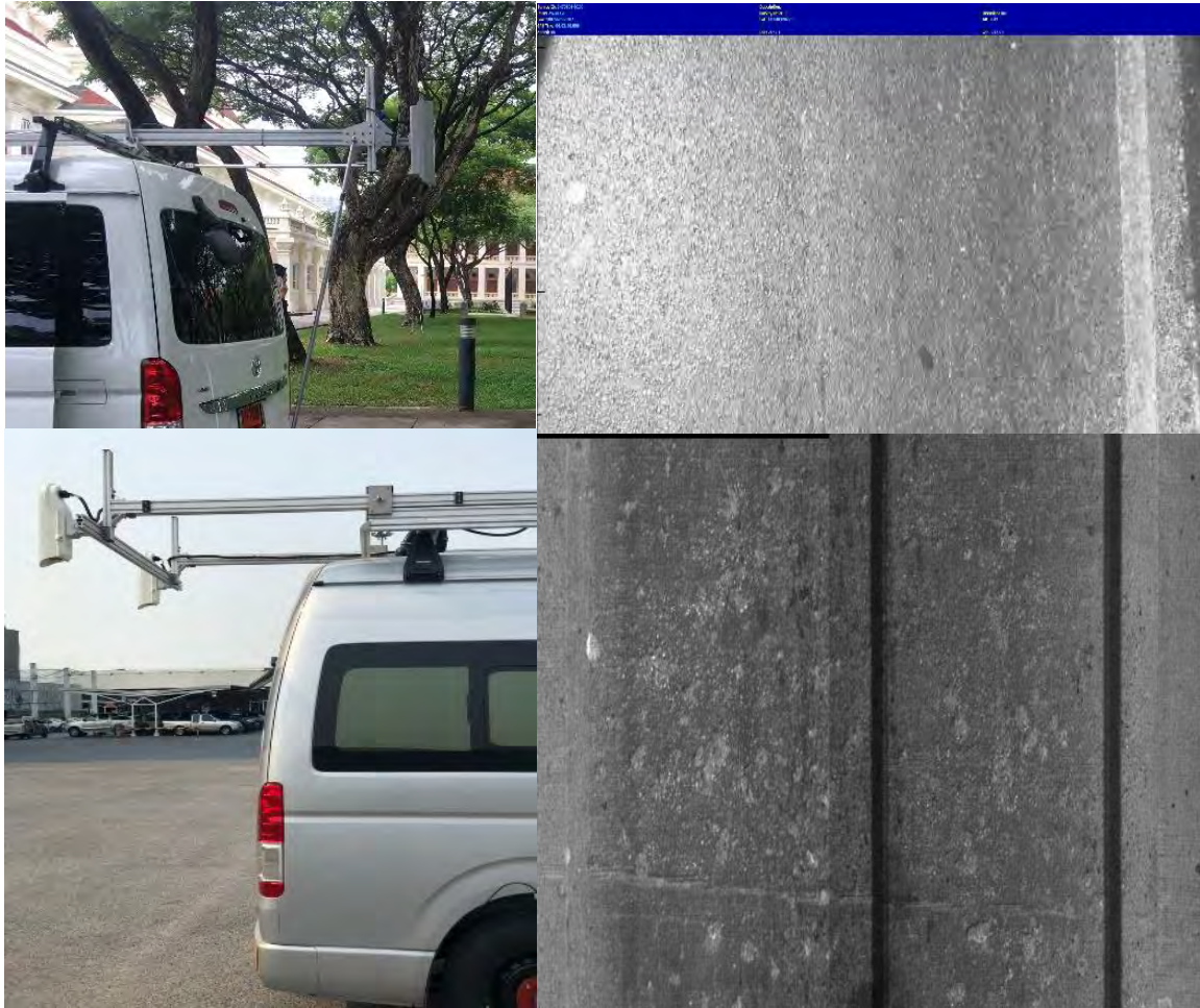
รูปที่ 1-20 กล้องบันทึกภาพผิวทาง และตัวอย่างภาพจากกล้องบันทึกภาพผิวทาง
