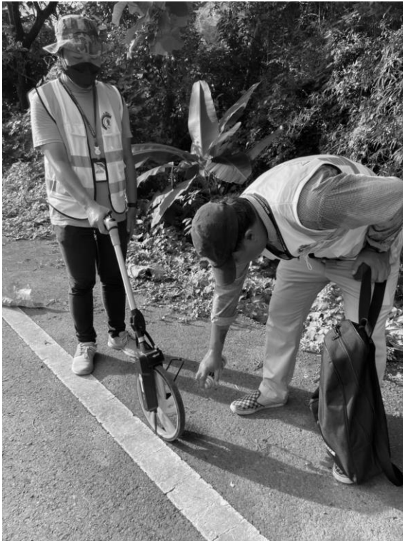
รูปที่ 1-164 การกำหนดตำแหน่งรังวัดค่าพิกัดโดยใช้ล้อวัดระยะ 25 เมตร
