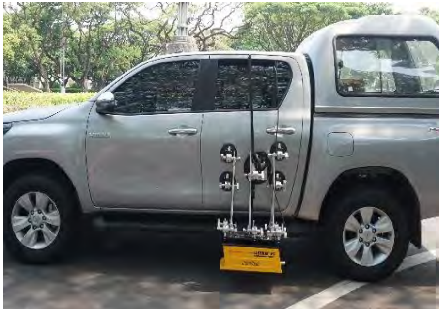
รูปที่ 1-228 ตัวอย่างการติดตั้งเครื่องมือ Pavement Marking Retro Reflectivity กับยานพาหนะ
