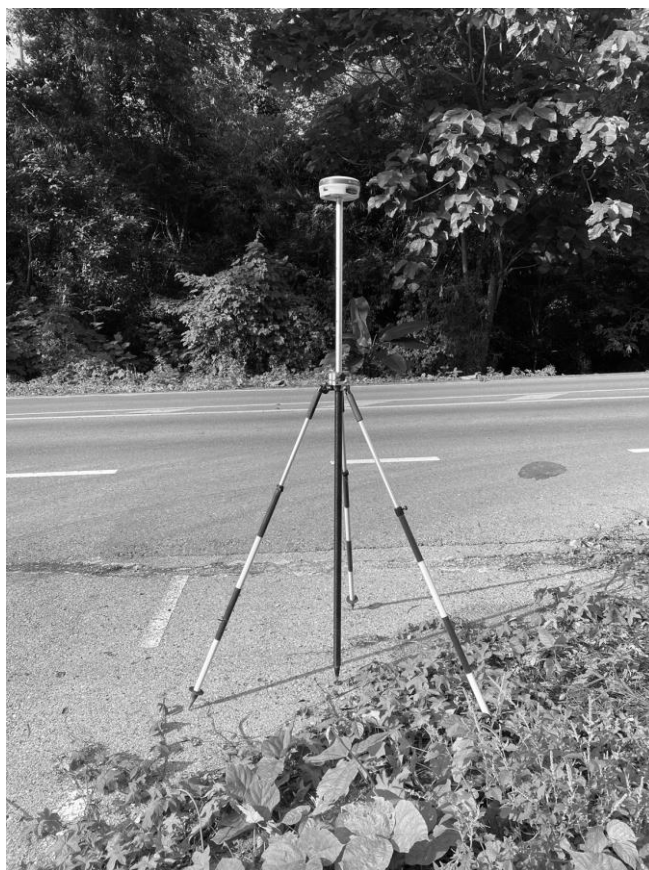
รูปที่ 1-162 การรังวัดตำแหน่งหมุดสถานีฐานชั่วคราว
