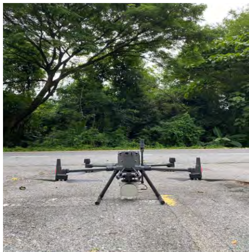
รูปที่ 1-166 อากาศยานไร้คนขับพร้อมติดตั้งเครื่อง LIDAR
