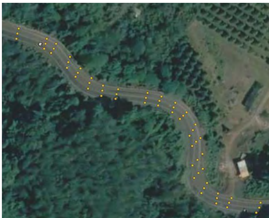
รูปที่ 1-161 ข้อมูลจุดพิกัดที่ได้จาก อุปกรณ์รับสัญญาณ GNSS แบบ RTK
