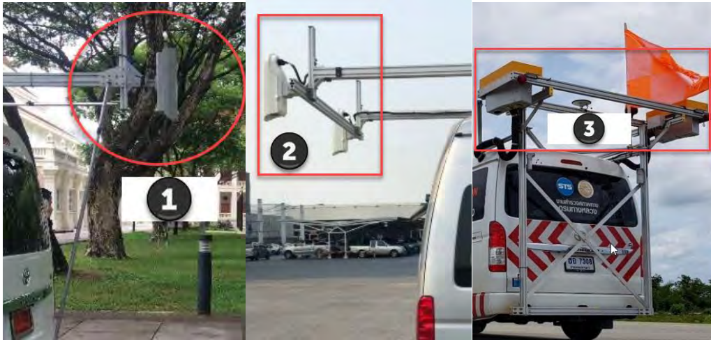
รูปที่ 1-184 ภาพแสดงตำแหน่งอุปกรณ์ที่ใช้ในการจัดเก็บภาพถ่ายผิวทางของรถสำรวจ คันที่ 1, คันที่ 2 และคันที่ 3 ตามลำดับ
