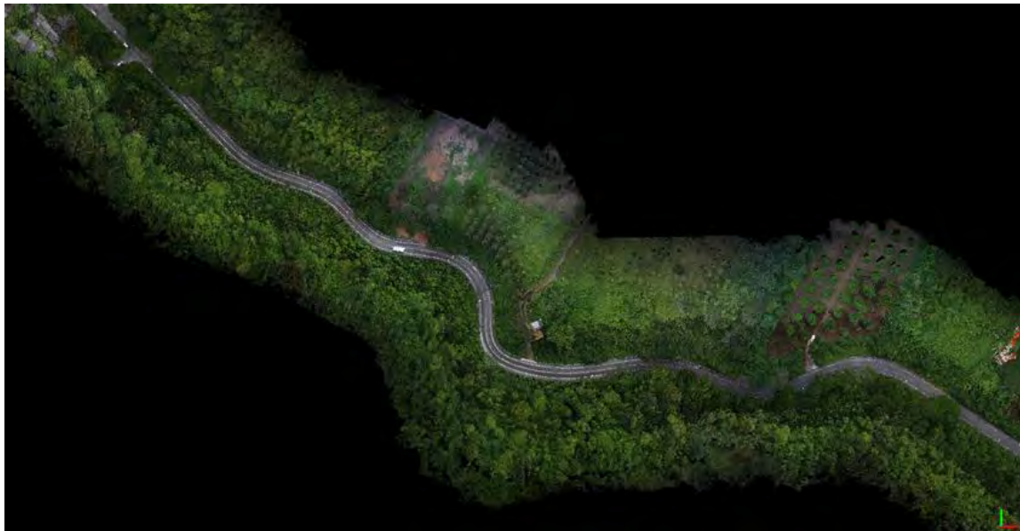
รูปที่ 1-159 ข้อมูล Point cloud จากอุปกรณ์ Lidar Drone
