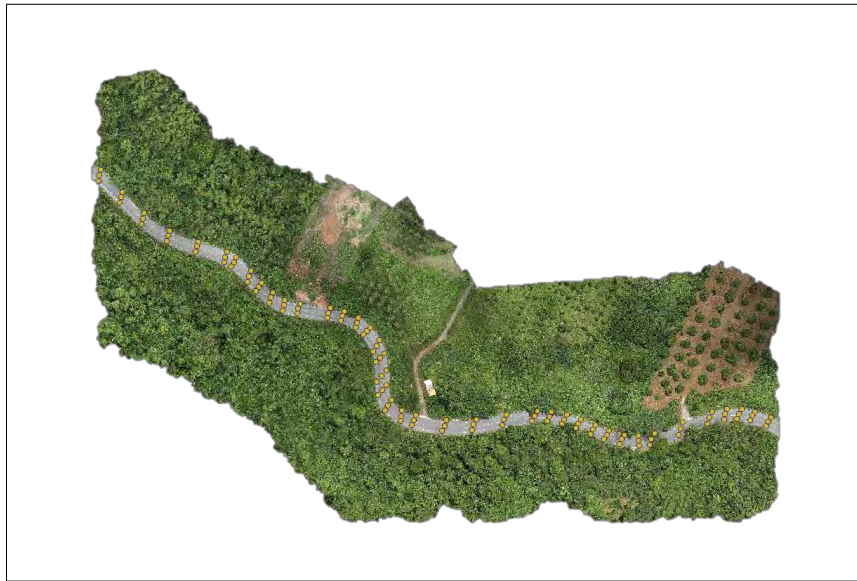
รูปที่ 1-167 ข้อมูล RTK GNSS เมื่อเปิดซ้อนทับกับข้อมูล Drone Lidar
