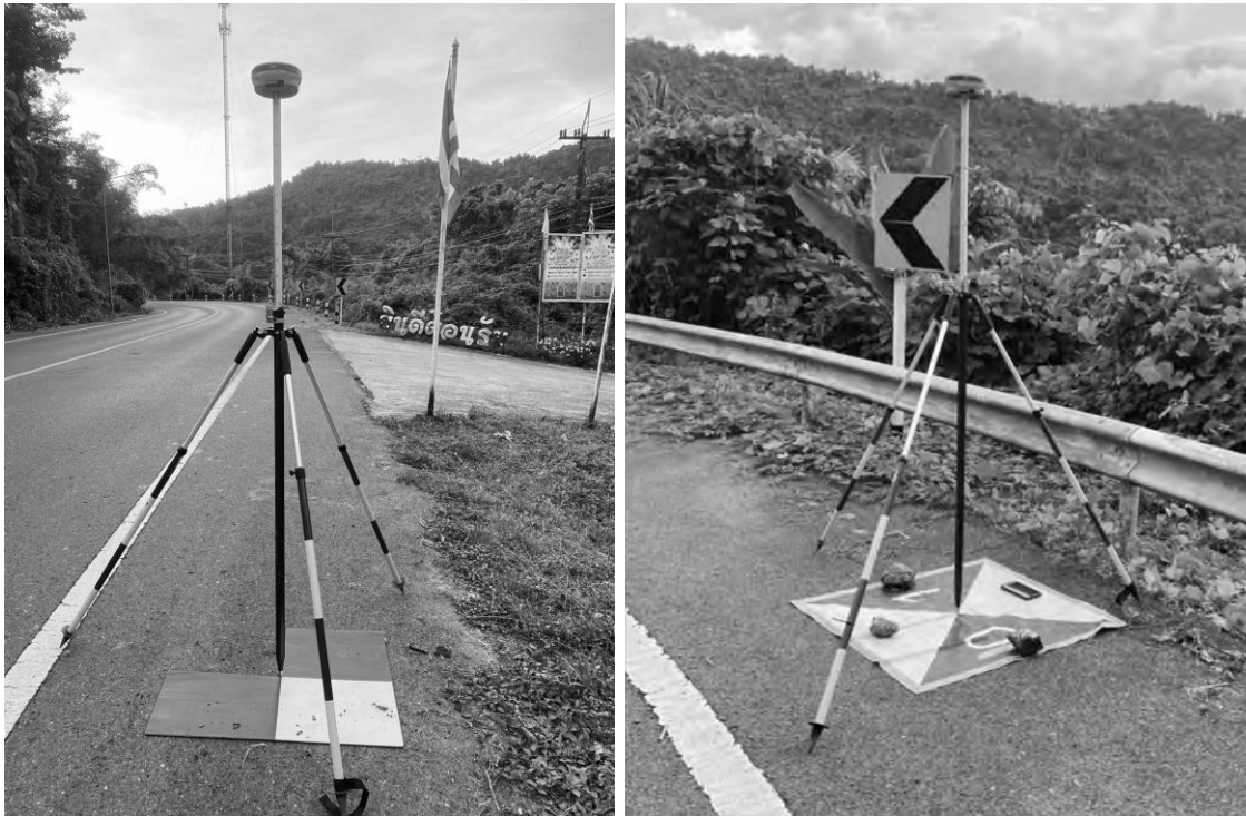
รูปที่ 1-163 การรังวัดจุดควบคุมภาคพื้นดินด้วยเครื่องวัดด้วยดาวเทียม
