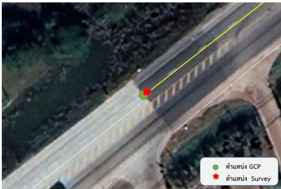
รูปที่ 91 แสดงจุด GCP และจุดที่ทำการตรวจสอบ ตำแหน่งที่ 19 แขวงทางหลวงสกนครที่ 2 (สว่างแดนดิน) สายทาง 22 ตอนควบคุม 0301
