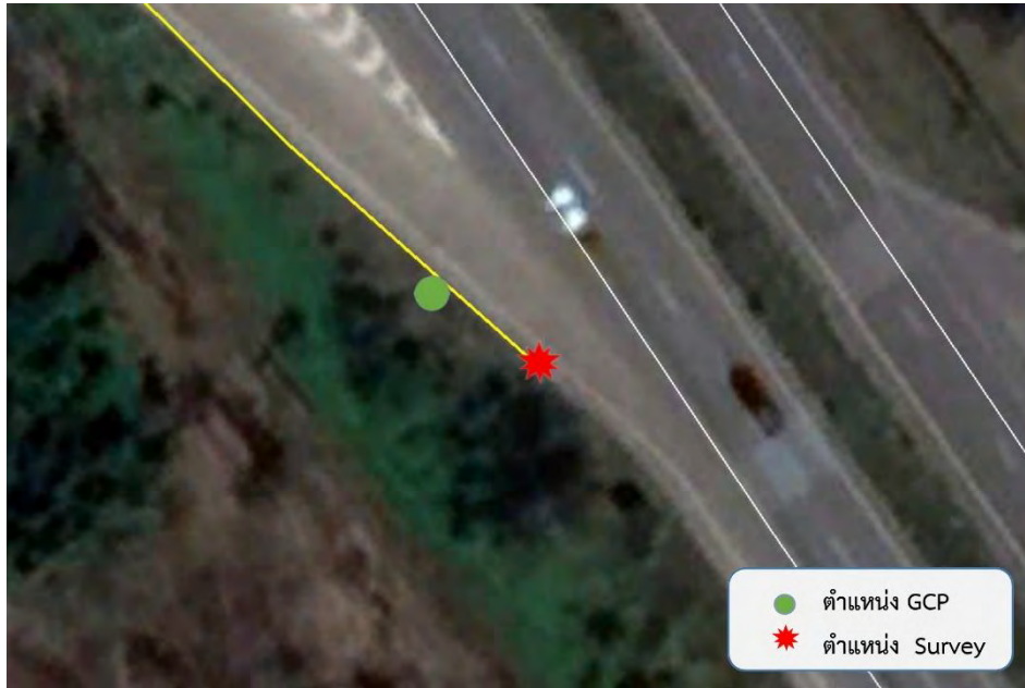
รูปที่ 123 แสดงจุด GCP และจุดที่ทำการตรวจสอบ ตำแหน่งที่ 51 แนวทางหลวงอุดรธานีที่ 1 สายทาง 2 ตอนควบคุม 0601
