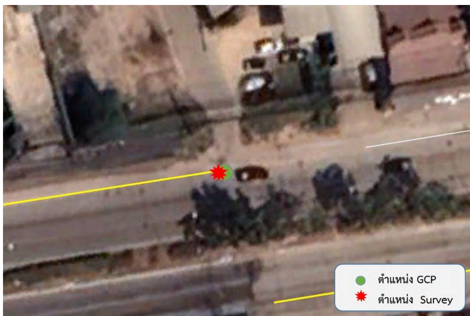
รูปที่ 118 แสดงจุด GCP และจุดที่ทำการตรวจสอบ ตำแหน่งที่ 46 แขวงทางหลวงเลขที่ 1 สายทาง 21 ตอนควบคุม 0700
