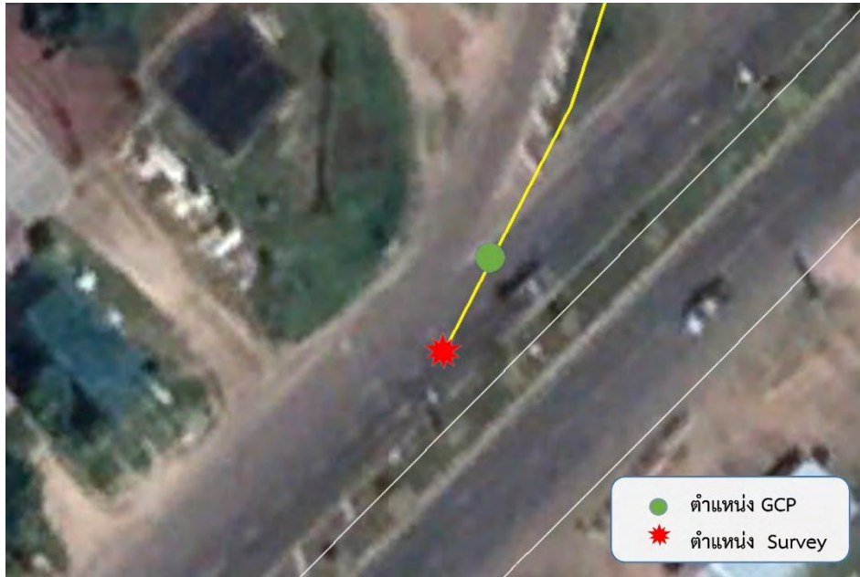
รูปที่ 143 แสดงจุด GCP และจุดที่ทำการตรวจสอบ ตำแหน่งที่ 71 แนวทางหลวงอุบลราชธานีที่ 2 สายทาง 24 ตอนควบคุม 0701
