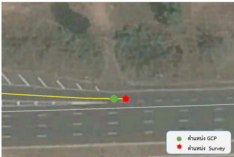
รูปที่ 140 แสดงจุด GCP และจุดที่ทำการตรวจสอบ ตำแหน่งที่ 68 แขวงทางหลวงสุรินทร์ สายทาง 24 ตอนควบคุม 0402
