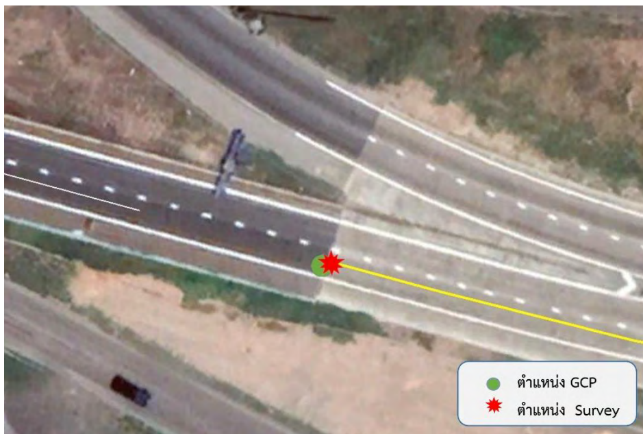
รูปที่ 193 แสดงจุด GCP และจุดที่ทำการตรวจสอบ ตำแหน่งที่ 121 แขวงทางหลวงธนบุรี สายทาง 9 ตอนควบคุม 0101
