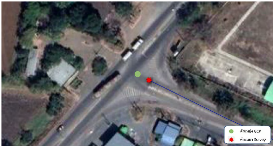
รูปที่ 35 แสดงจุด GCP และจุดที่ทำการตรวจสอบ ตำแหน่งที่ 34 แขวงทางหลวงลพบุรีที่ 2 (ลำน้ำรายณ์) สายทาง 2340 ตอนควบคุม 0100
