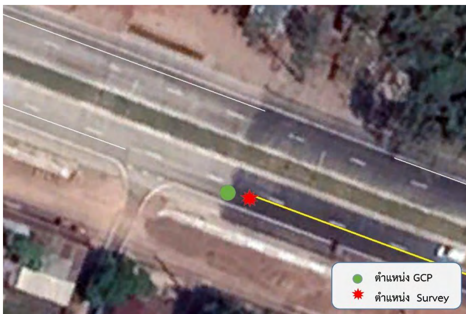
รูปที่ 92 แสดงจุด GCP และจุดที่ทำการตรวจสอบ ตำแหน่งที่ 20 แขวงทางหลวงสกนครที่ 2 (สว่างแดนดิน) สายทาง 22 ตอนควบคุม 0302
