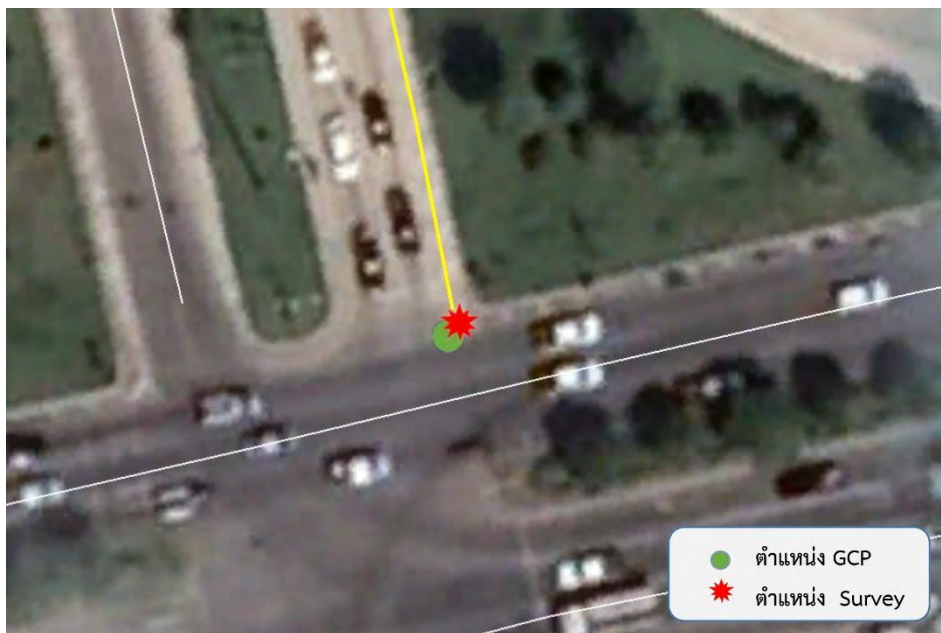
รูปที่ 204 แสดงจุด GCP และจุดที่ทำการตรวจสอบ ตำแหน่งที่ 132 แนวทางหลวงระยอง สายทาง 344 ตอนควบคุม 0202
