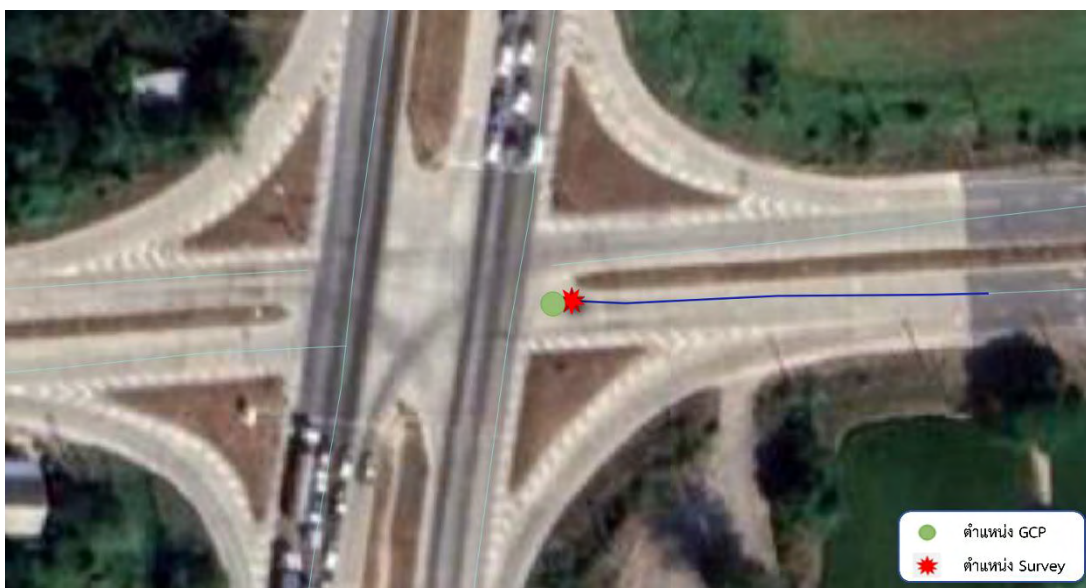
รูปที่ 59 แสดงจุด GCP และจุดที่ทำการตรวจสอบ ตำแหน่งที่ 58 แขวงทางหลวงพิจิตร สายทาง 1276 ตอนควบคุม 0100
