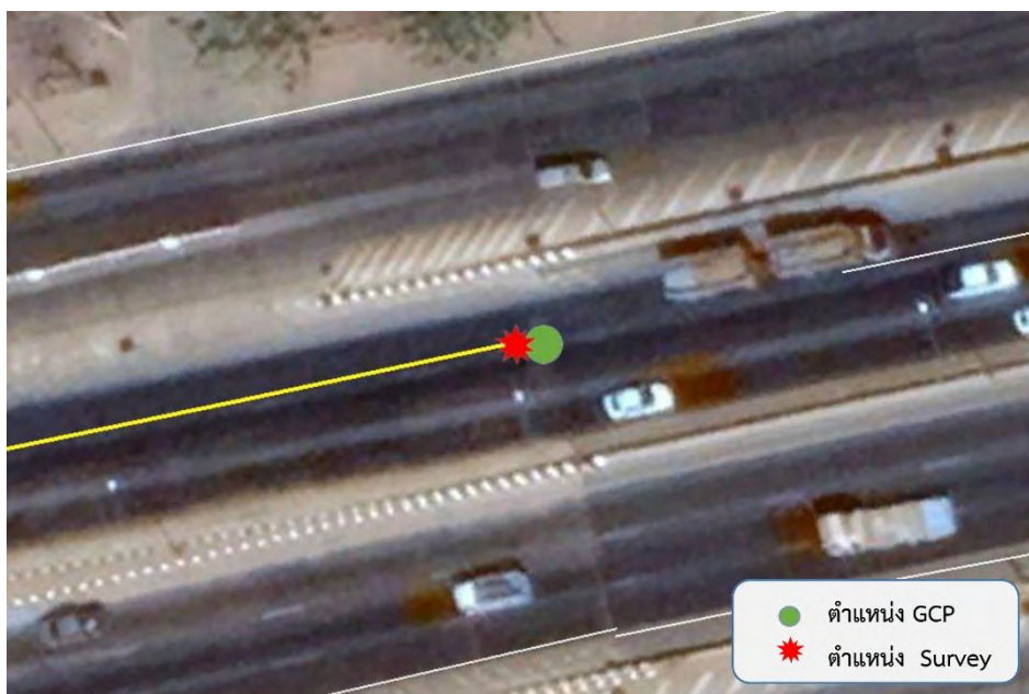
รูปที่ 214 แสดงจุด GCP และจุดที่ทำการตรวจสอบ ตำแหน่งที่ 142 แนวทางหลวงนครปฐม สายทาง 4 ตอนควบคุม 0202
