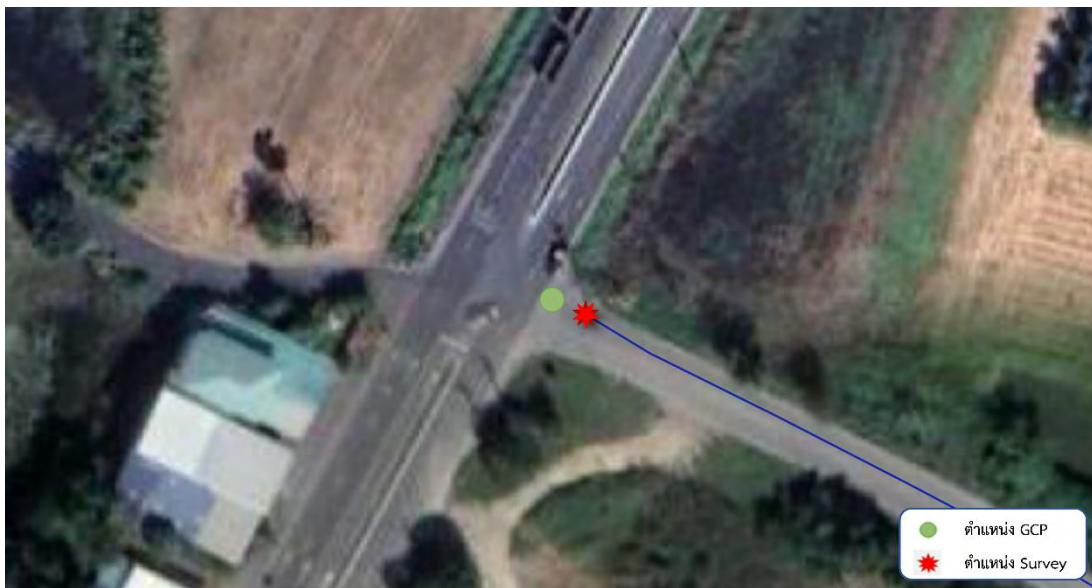
รูปที่ 31 แสดงจุด GCP และจุดที่ทำการตรวจสอบ ตำแหน่งที่ 30 แขวงทางหลวงสระบุรี สายทาง 3250 ตอนควบคุม 0100
