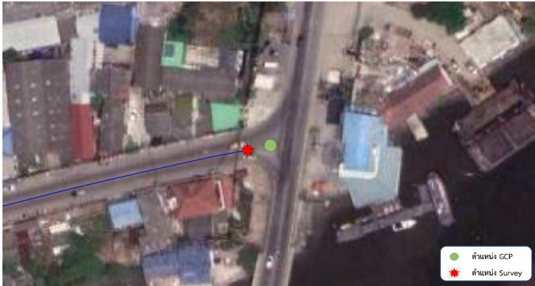
รูปที่ 12 แสดงจุด GCP และจุดที่ทำการตรวจสอบ ตำแหน่งที่ 11 แขวงทางหลวงสมุทรปราการ สายทาง 3243 ตอนควบคุม 0100
