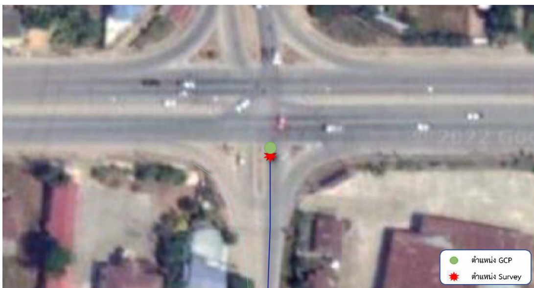
รูปที่ 53 แสดงจุด GCP และจุดที่ทำการตรวจสอบ ตำแหน่งที่ 52 แขวงทางหลวงสุโขทัย สายทาง 1053 ตอนควบคุม 0100
