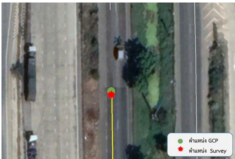
รูปที่ 192 แสดงจุด GCP และจุดที่ทำการตรวจสอบ ตำแหน่งที่ 120 แนวทางหลวงนทบุรี สายทาง 9 ตอนควบคุม 0202
