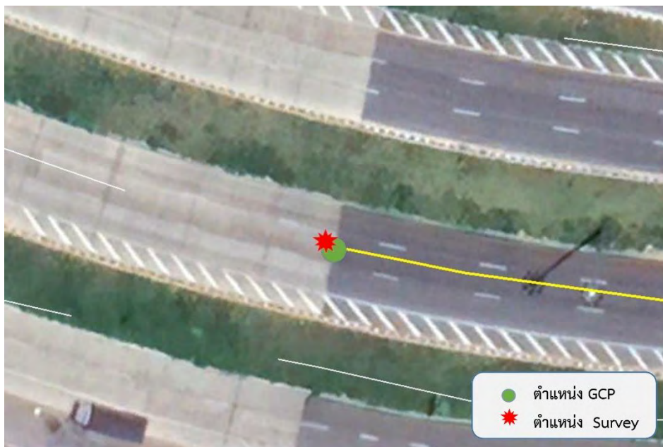
รูปที่ 239 แสดงจุด GCP และจุดที่ทำการตรวจสอบ ตำแหน่งที่ 167 แนวทางหลวงสงขลาที่ 1 สายทาง 4 ตอนควบคุม 1402
