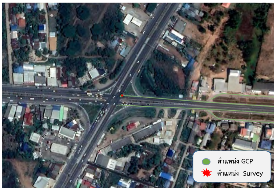
รูปที่ 321 แสดงจุด GCP และจุดที่ทำการตรวจสอบ ตำแหน่งที่ 78 แขวงทางหลวงกาฬสินธุ์ สายทาง 2116 ตอนควบคุม 0101
