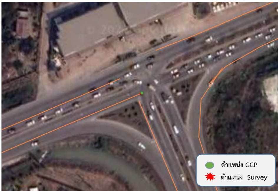
รูปที่ 303 แสดงจุด GCP และจุดที่ทำการตรวจสอบ ตำแหน่งที่ 60 แนวทางหลวงอุดรธานีที่ 1 สายทาง 0210 ตอนควบคุม 0100
