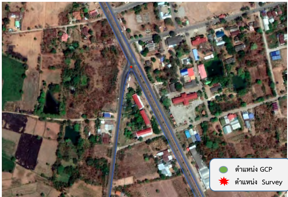
รูปที่ 308 แสดงจุด GCP และจุดที่ทำการตรวจสอบ ตำแหน่งที่ 65 แขวงทางหลวงชัยภูมิ สายทาง 2354 ตอนควบคุม 0102
