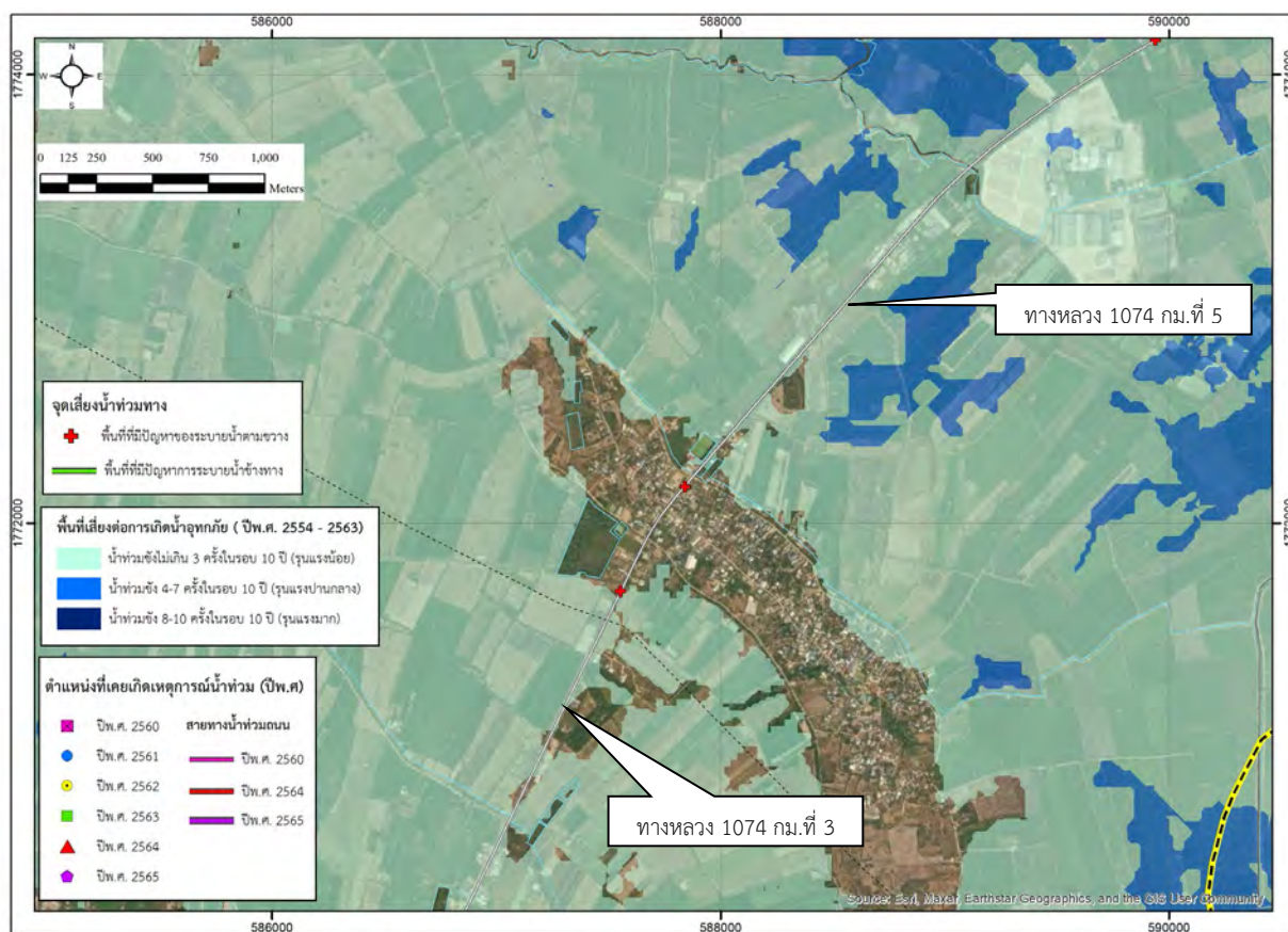
รูปที่ 3.2-8 ปัญหาน้ำท่วมขังทางหลวงหมายเลข 1074 ช่วง กม.ที่ 3 ถึง 5
