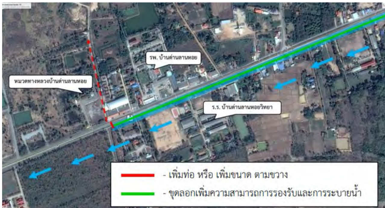
รูปที่ 2.4-17 แนวทางการแก้ไขการระบายน้ำทางหลวงหมายเลข 12 บริเวณ กม.147+400
