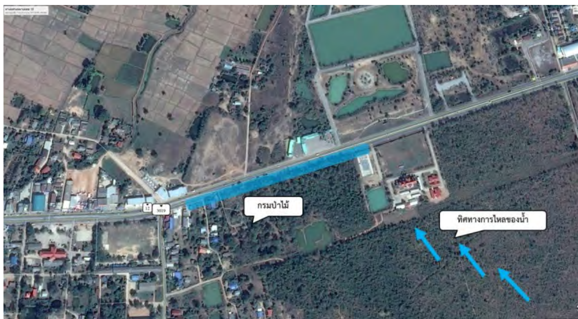
รูปที่ 2.4-12 ลักษณะการไหลท่วมสายทางหลวงหมายเลข 12 บริเวณ กม.145+600
