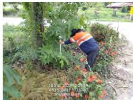
รูปที่ 6.2-2 การสำรวจรังวัด สำหรับตำแหน่งการปรับปรุงอาคารระบายน้ำด้วยวิธี RTK
