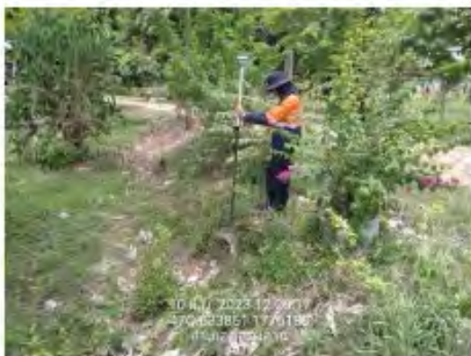
รูปที่ 6.2-2 การสำรวจรังวัด สำหรับตำแหน่งการปรับปรุงอาคารระบายน้ำด้วยวิธี RTK
