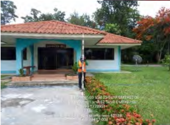
รูปที่ 6.2-1 การโยนโครงข่ายหมุดหลักฐาน GPS ด้วยเครื่องรับสัญญาณดาวเทียม
