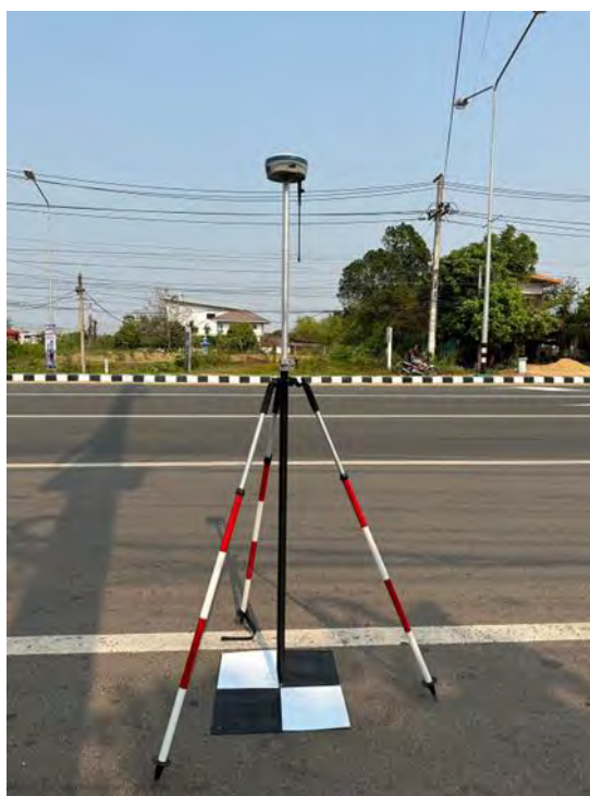
รูปที่ 7 เครื่องรับสัญญาณดาวเทียม GNSS
