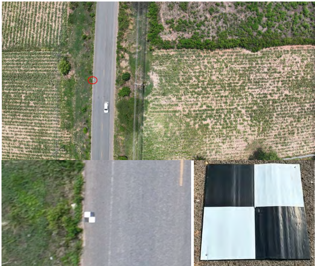
รูปที่ 6 ภาพแสดงตำแหน่งจุดตรวจสอบภาพ Check Point (CP)
