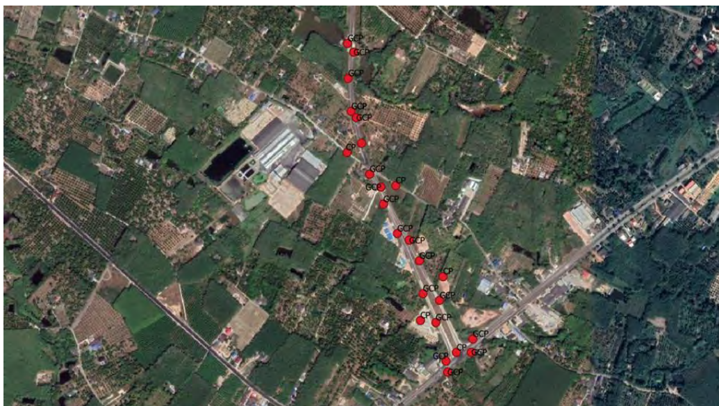
รูปที่ 8 ตัวอย่าง การกำหนดตำแหน่งการจุดควบคุมภาคพื้นดิน Ground Control Point (GCP) ตามแนวเส้นทาง (Corridor)
