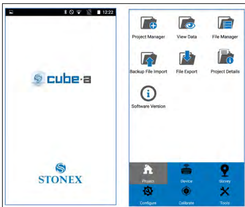
รูปที่ 10 แสดงหน้าต่างซอฟต์แวร์เพื่อรังวัดค่าพิกัดบนอุปกรณ์คอมพิวเตอร์ Tablet
