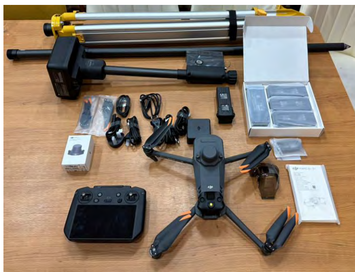
รูปที่ 28 ตัวอย่าง อากาศยานไร้คนขับชนิดปีกหมุน (Multirotor) ยี่ห้อ DJI รุ่น Mavic 3 Enterprise
