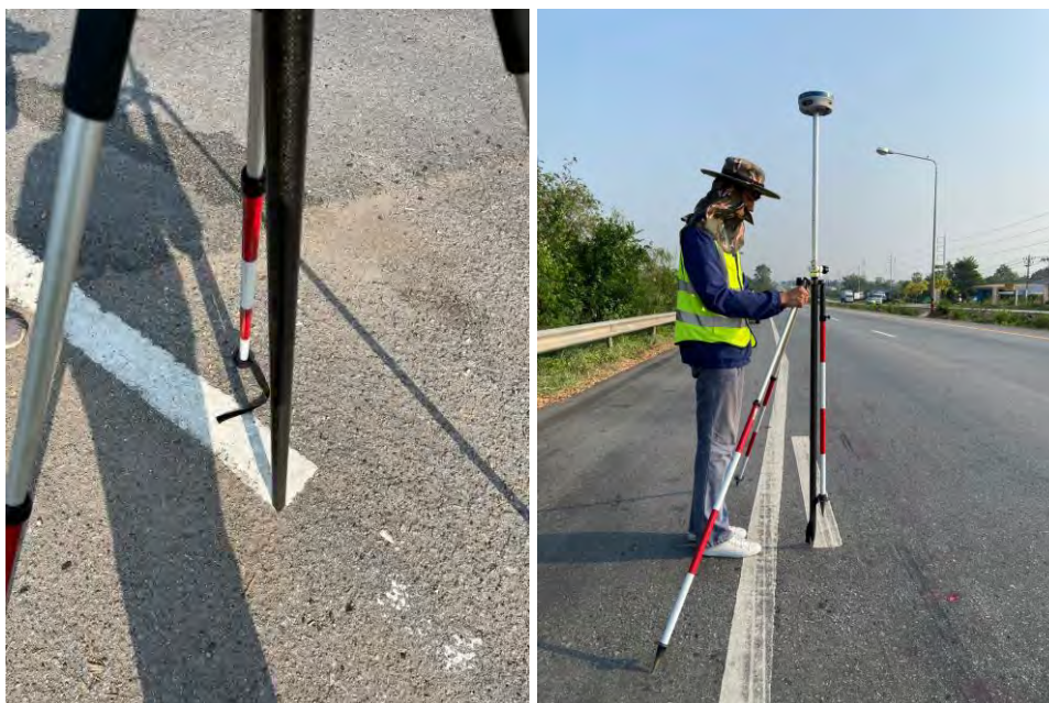
รูปที่ 4 ภาพตัวอย่างการสร้างจุดควบคุมภาคพื้นดิน Ground Control Point (GCP) และจุดตรวจสอบภาพ Check Point (CP) แบบ Well Defined Point
