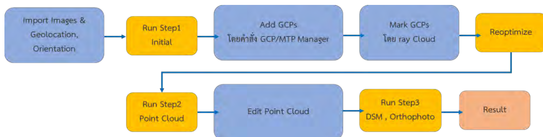
รูปที่ 44 แผนผังแสดงขั้นตอนการประมวลผลข้อมูลภาพถ่ายโดยโปรแกรม Pix4DMapper
