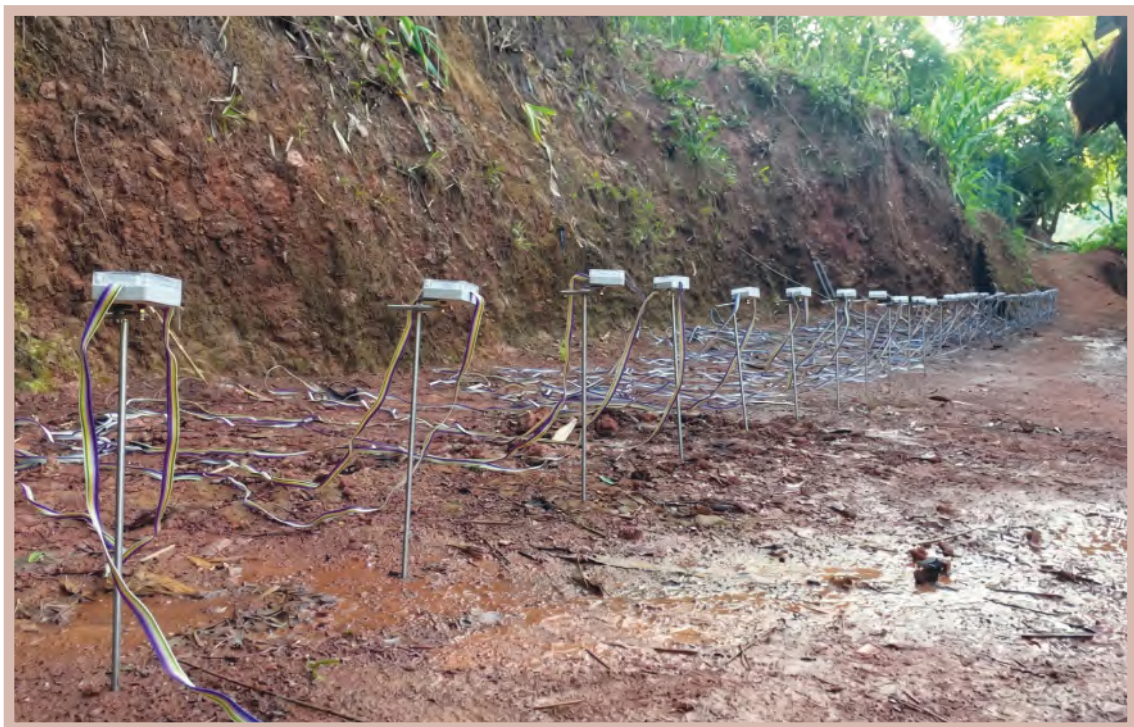
รูปที่ 2-8 ตัวอย่างการใช้เครื่องมือเพื่อตรวจวัดค่าความต้านทานไฟฟ้าของชั้นดิน ที่มา : คณะผู้จัดทำ เมื่อวันที่ 5 มิถุนายน 2562
