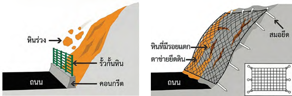
รูปที่ 2-17 รั้วกันหิน (catch fence) และ ตาข่ายยึดดิน (rockfall net) ที่มา : ดัดแปลงจาก Road Geohazard Risk Management Handbook 31
