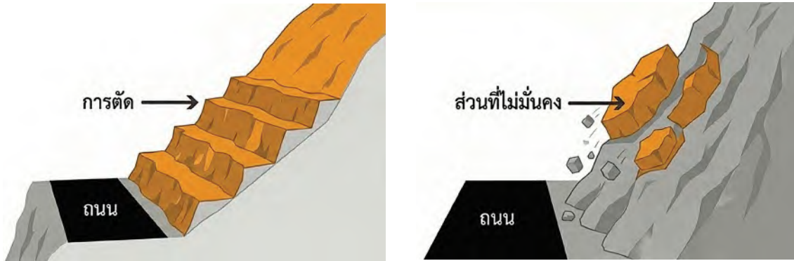
รูปที่ 2-12 การตัดปรับความลาดชัน (slope cutting) และการสกัดส่วนที่ไม่มั่นคง (trimming scaling)
