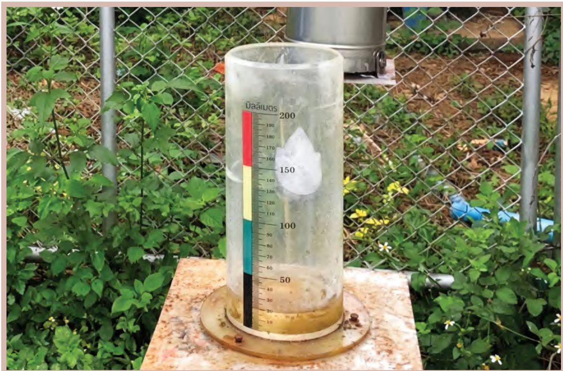
รูปที่ 2-3 ตัวอย่างเครื่องมือตรวจวัดน้ำฝนบริเวณบ้านปางสา จังหวัดน่าน ที่มา : ถ่ายโดยคณะผู้จัดทำ เมื่อวันที่ 4 มิถุนายน 2562
