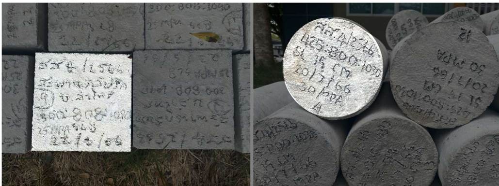
ภาพที่ 1 การเขียนรายละเอียดลงบนผิวหน้าของแท่งคอนกรีตทรงลูกบาศก์ และแท่งทรงกระบอก
