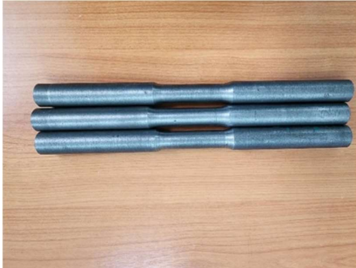
ภาพที่ 7 ตัวอย่างเหล็กหล่อเทา ขนาดเส้นผ่านศูนย์กลาง 20 มม. ความยาว 40 ซม.
