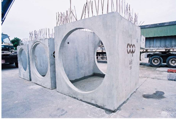
ภาพที่ 26 บ่อพัก (MANHOLE)
