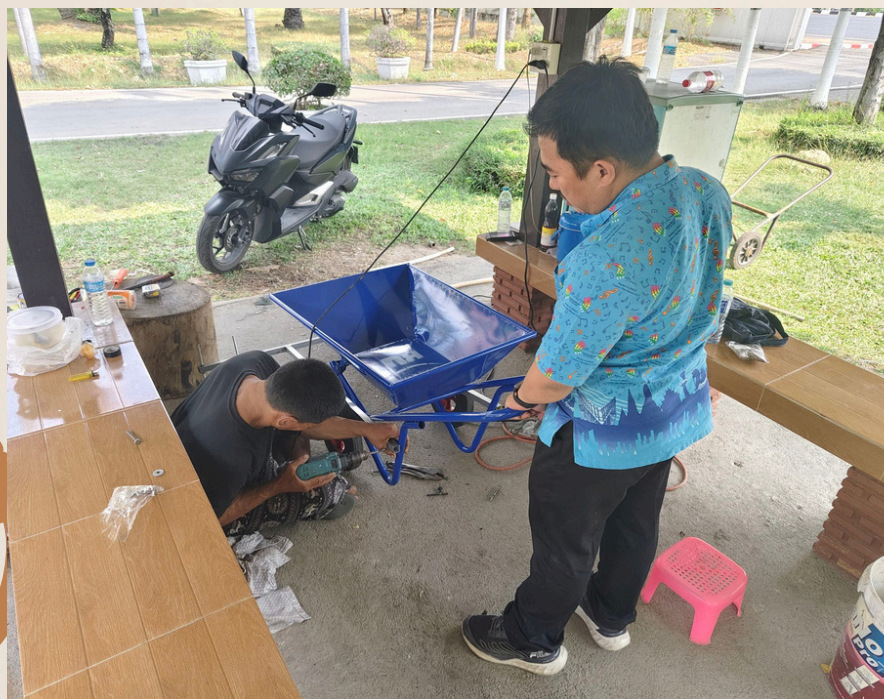
3. เจาะอุปกรณ์ทำความสะอาดในล้อเข้ากับรถเข็นเพื่อทำการติดตั้ง
