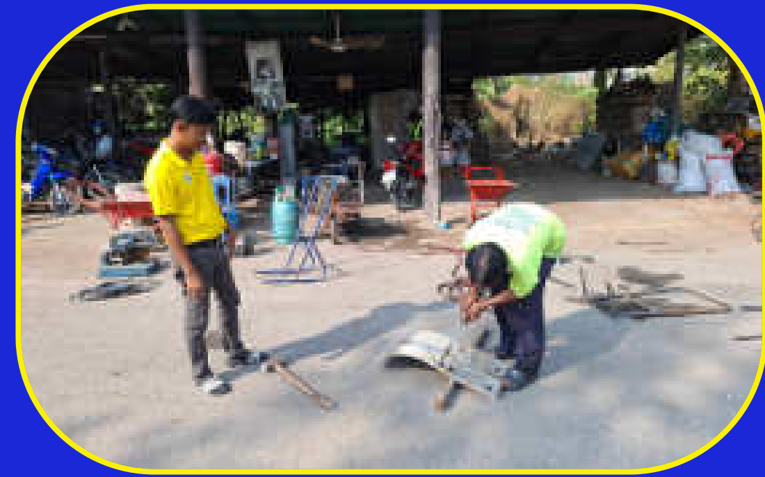
2. นำแผ่นปลายปิดราวกันอันตรายที่ชำรุดมาตัดคืนสภาพและตัดเพื่อทำเป็นบุ้งกึ่งักดิน
