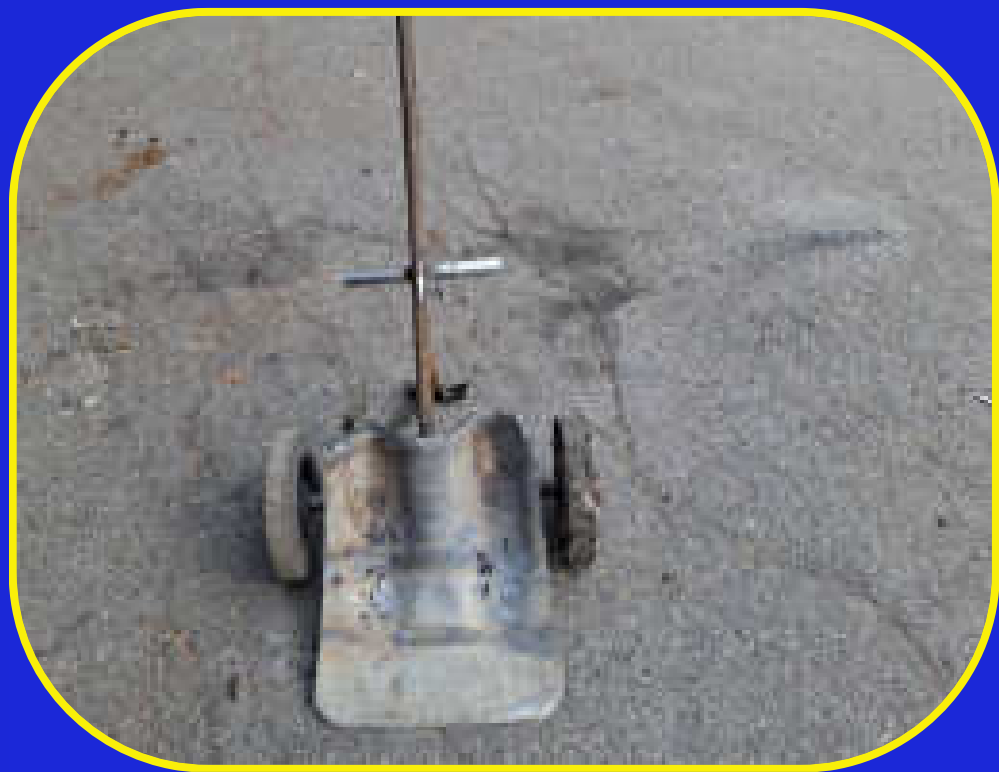
3. นำล้อรถเข็นและแกนมาติดตั้งเพื่อเป็นฐานล้อขับเคลื่อน
