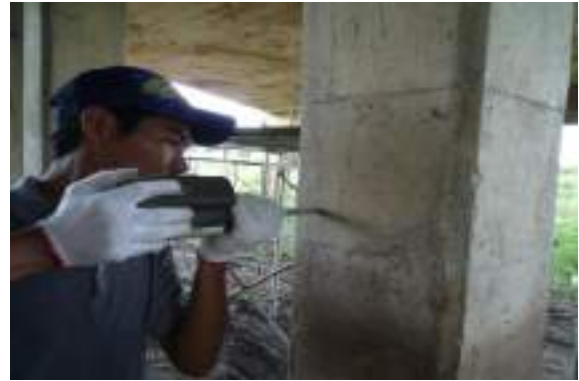
รูปที่ 5-36 เครื่อง Rebound Hammer และวิธีการทดสอบด้วยวิธี Compressive Strength
