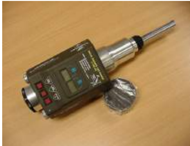
รูปที่ 3-11 เครื่องมือ Digital Concrete Test Hammer
