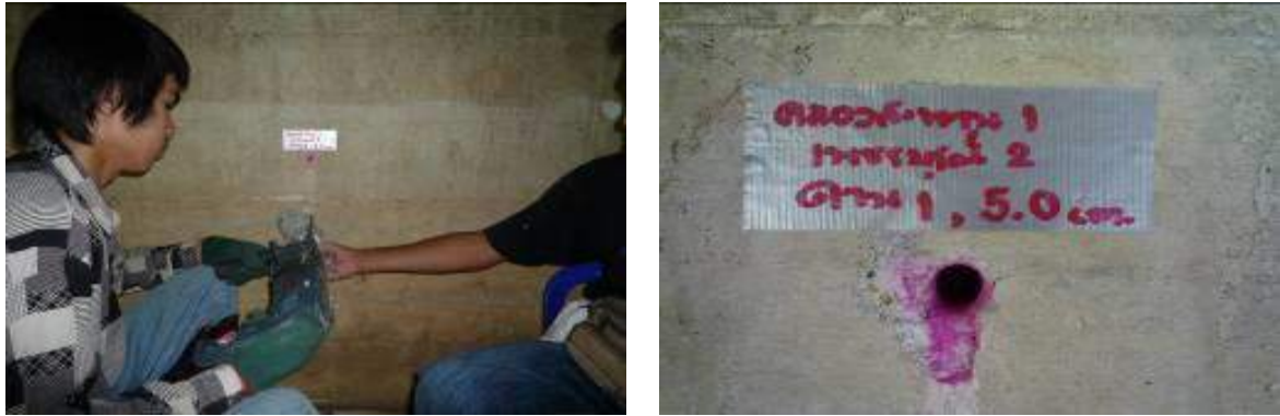
รูปที่ 5-38 วิธีการทดสอบด้วยวิธี การเกิดปฏิกิริยาคาร์บอนเนชั่น
