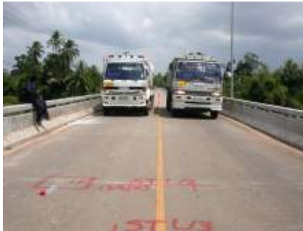
รูปที่ 5-40 การทดสอบการรับน้ำหนักบรรทุกทุกจริง
