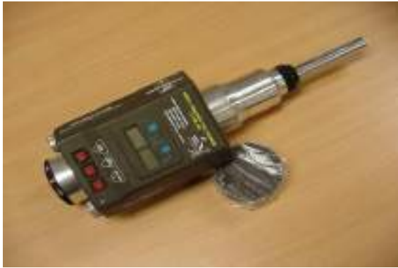
รูปที่ 5-36 เครื่อง Rebound Hammer และวิธีการทดสอบด้วยวิธี Compressive Strength
